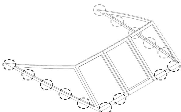
Устанавливаем рамку на место и фиксируем ее на лодке винтами через подготовленные ранее отверстия.
