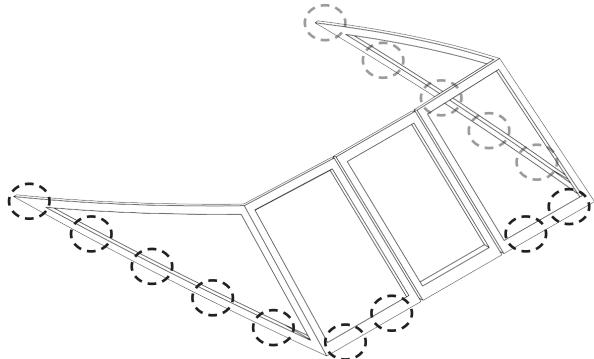
В нижнем профиле рамки есть отверстия, через которые будет осуществляться крепление ветрового стекла к корпусу лодки. В случае если по какой-то причине вы не можете использовать данные отверстия, необходимо самостоятельно просверлить профиль рамки в ближайшем доступном месте используя для этого сверло диаметром 4,8-5 мм.
