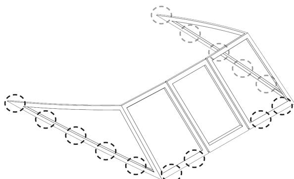
Затем в отмеченных ранее точках, с помощью сверла 4,8 мм в палубе лодки просверливаем отверстия и фиксируем рамку к корпусу лодки винтами M4x40
