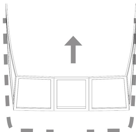
7.1 Откручиваем рамку от палубы лодки и снимаем её.
