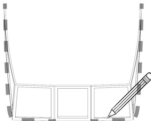
Очерчиваем контур рамки карандашом для наклеивания уплотнителя (под рамку) с клеевой основой.
