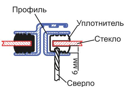
Сверловка бокового профиля для крепления упорных стоек.
