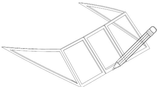
Для дальнейшего, точного, позиционирования ветрового стекла относительно оси симметрии лодки. Так же необходимо отметить центр палубы в районе выхода (калитки).
